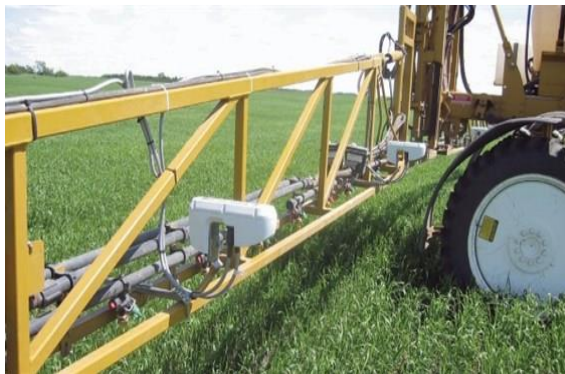
Slika 90. Greenseeker senzori postavljeni na grane prskalice
