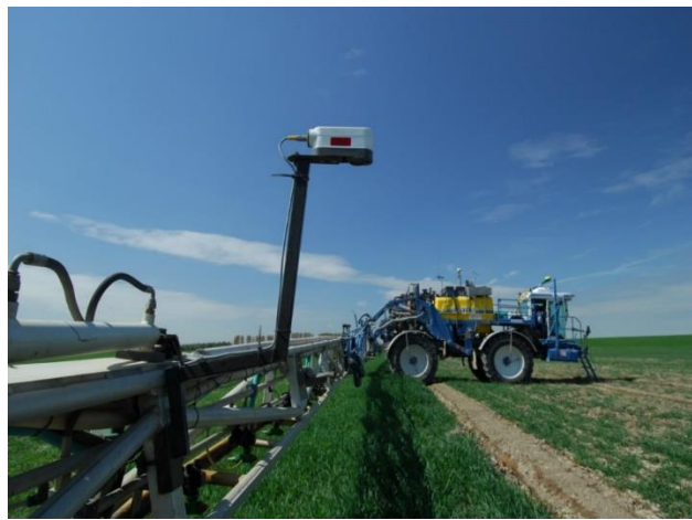
Slika 86. Ag Leader OptRx senzor postavljen na krila samohodne prskalice
