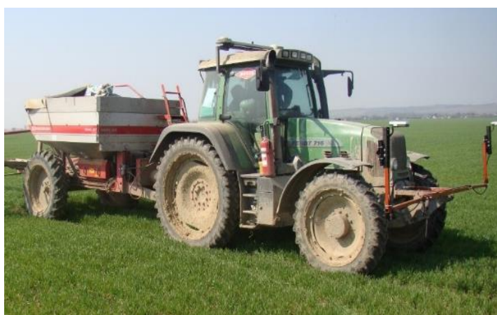
Slika 84. Prikaz Ag Leader OptRx senzora u radu u prihrani pšenice
