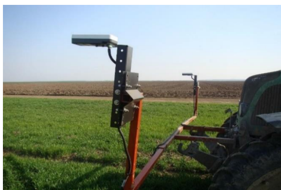
Slika 75. Način postavljenja OprRx senzora na traktor Fendt 716 Vario (Izvor: P. Marić, 2015.)
