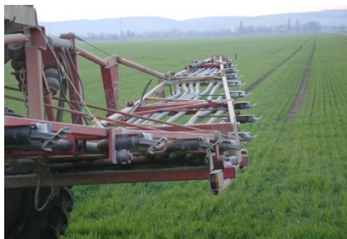
Slika 59. Kongskilde Owerum Wing Jet K-plus ploče rasipača okrenute prema gore (Izvor: P.Marić, 2015.)
