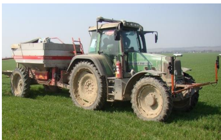
Slika 84. Prikaz Ag Leader OptRx senzora u radu u prihrani pšenice (Izvor: P. Marić, 2015.)
