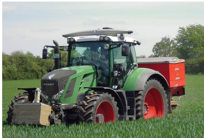
Slika 89. Yara dušični senzori postavljeni na kabinu traktora
