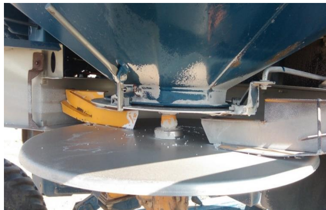
Slika 16. Ručice za podešavanje zatvarača
