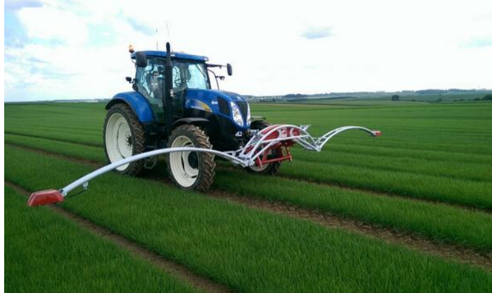
Slika 88. Fritzmeier senzori usjeva
