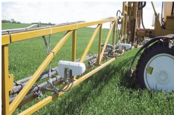
Slika 90. Greenseeker senzori postavljeni na grane prskalice
