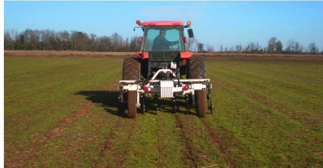
Slika 1. Skener Veris 3150 u radu
