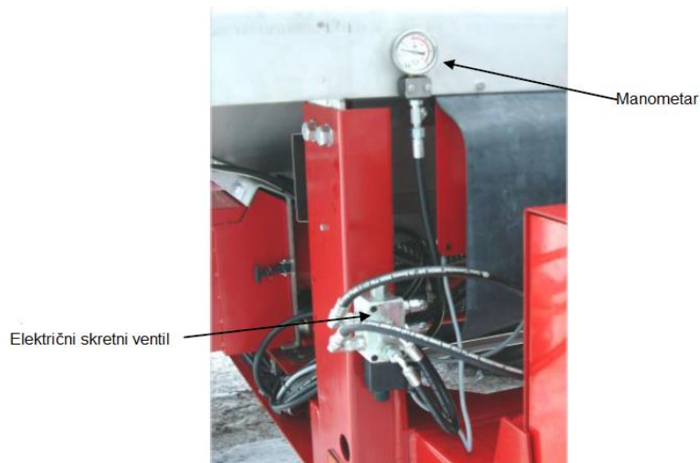
Slika 43. Manometar i električni skretni ventil na rasipaču Kongskilde Owerum Wing Jet (Izvor: http://www.kongskilde.com/sv/sv-SE/Agriculture/Soil/Fertilising%20technique/ )
