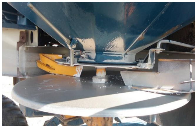
Slika 16. Ručice za podešavanje zatvarača (Izvor: P. Marić, 2015.)
