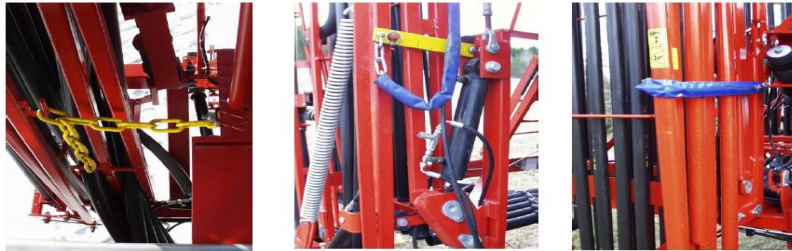
Slika 56. Mehanička transportna kopča za krilo ( 4012, 4020, 4024)
