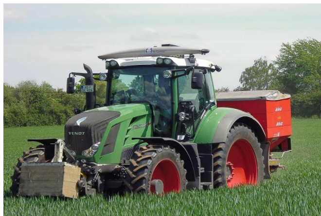
Slika 89. Yara dušični senzori postavljeni na kabinu traktora
