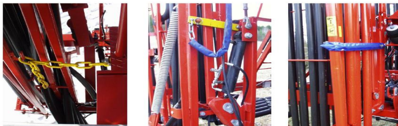
Slika 56. Mehanička transportna kopča za krilo ( 4012, 4020, 4024)
