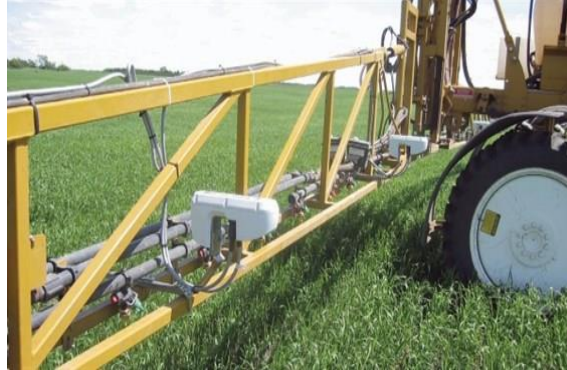
Slika 90. Greenseeker senzori postavljeni na grane prskalice
