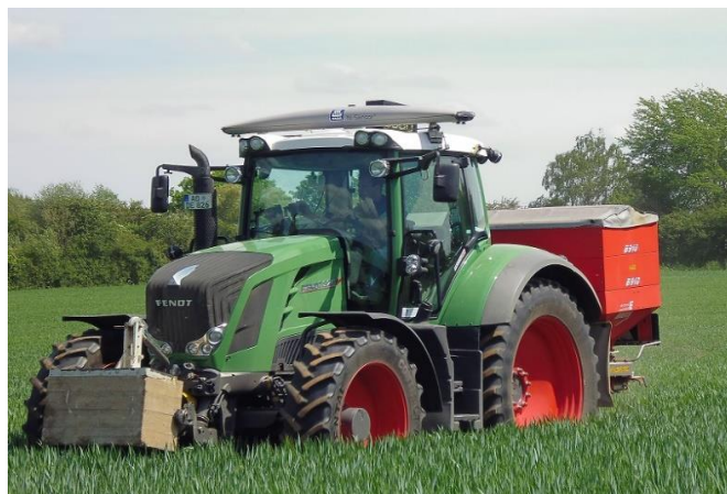
Slika 89. Yara dušični senzori postavljeni na kabinu traktora
