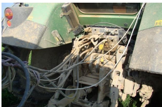
Slika 40. Spajanje hidrauličkog sustava traktora Fendt 716 Vario i rasipača Kongskilde Owerum Wing Jet K-plus Hidro S 4024
