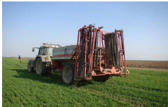
Slika 57. Kongskilde Owerum Wing Jet K-plus Hidro S 4024 u transportnom položaju
