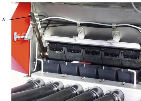
Slika 51. Vrata za doziranje
