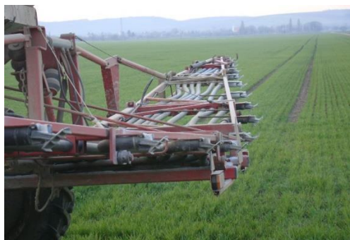
Slika 59. Kongskilde Owerum Wing Jet K-plus ploče rasipača okrenute prema gore (Izvor: P.Marić, 2015.)
