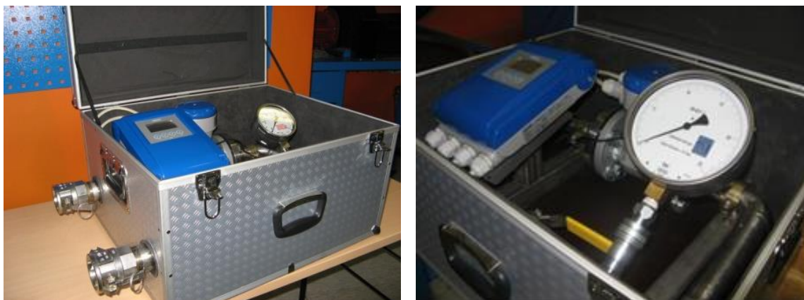
Slika 17. Elektromagnetni mjerač kapaciteta tvrtke Krohne
