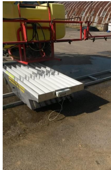
Slika 20. Uređaj za ispitivanje horizontalne raspodjele tekućine – spray scanner
