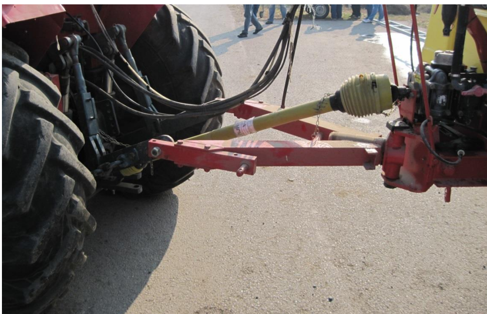
Slika 7. Propisano zaštićeno kardansko vratilo
