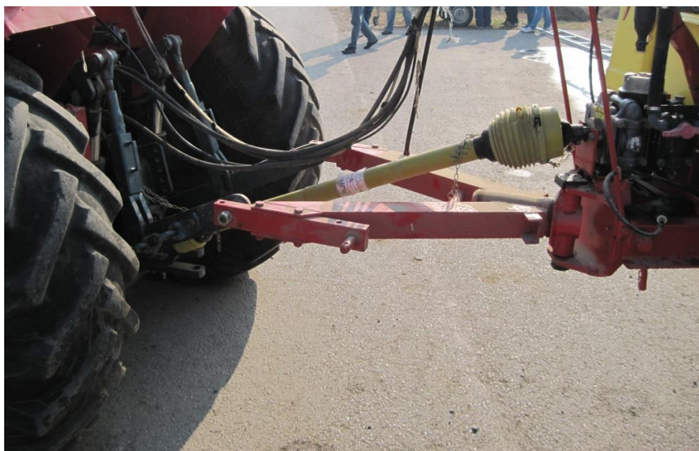
Slika 7. Propisano zaštićeno kardansko vratilo
