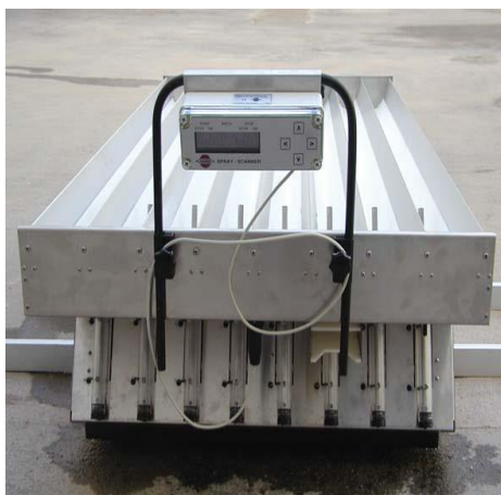
Slika 20. Uređaj za ispitivanje horizontalne raspodjele tekućine – spray scanner
