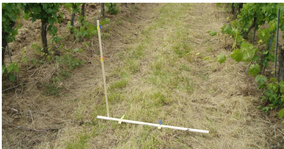
Slika 10. Mjerenje zanošenja pomoću VOP-a
