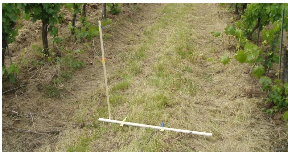
Slika 10. Mjerenje zanošenja pomoću VOP-a
