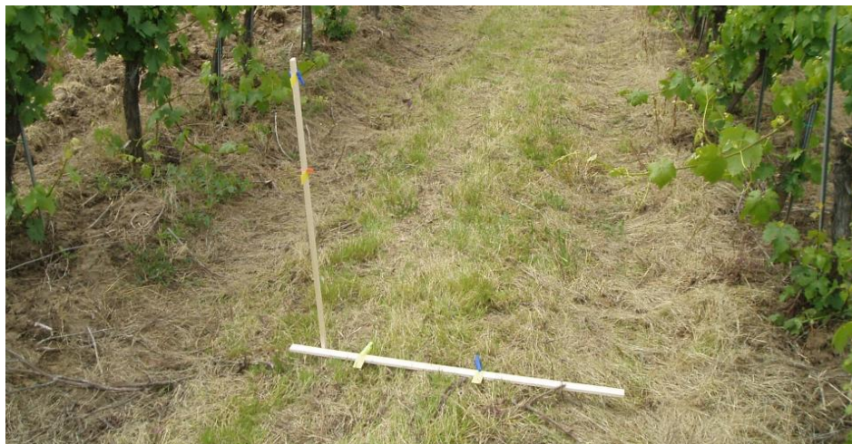
Slika 10. Mjerenje zanošenja pomoću VOP-a
