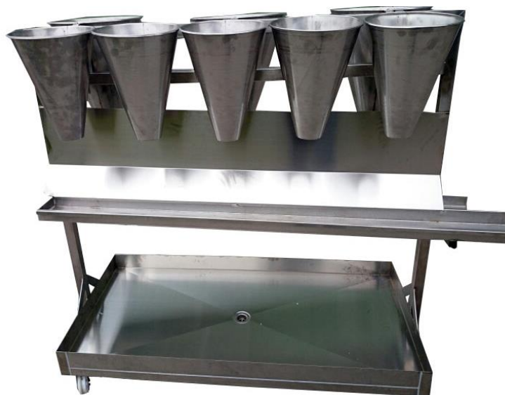
Slika 5. Stožac za iskrvarenje
