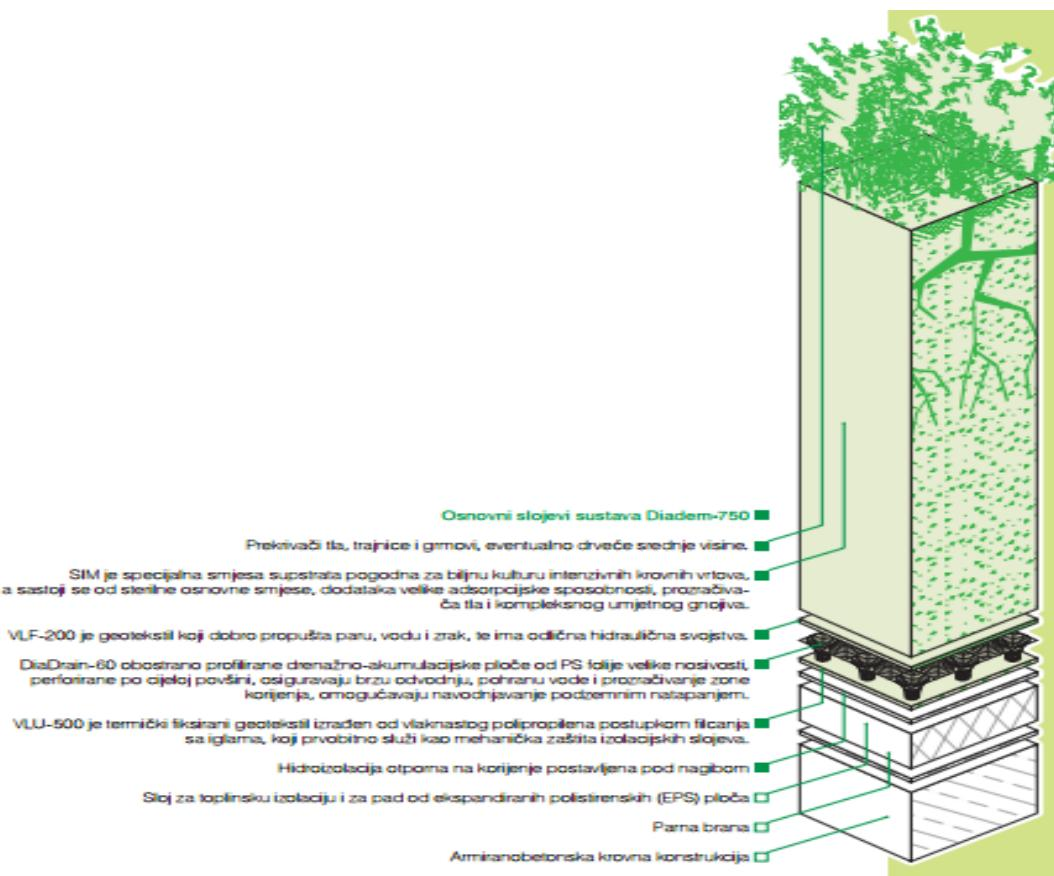
**Slika 10:** Osnovni slojevi sustava Diadem®750
