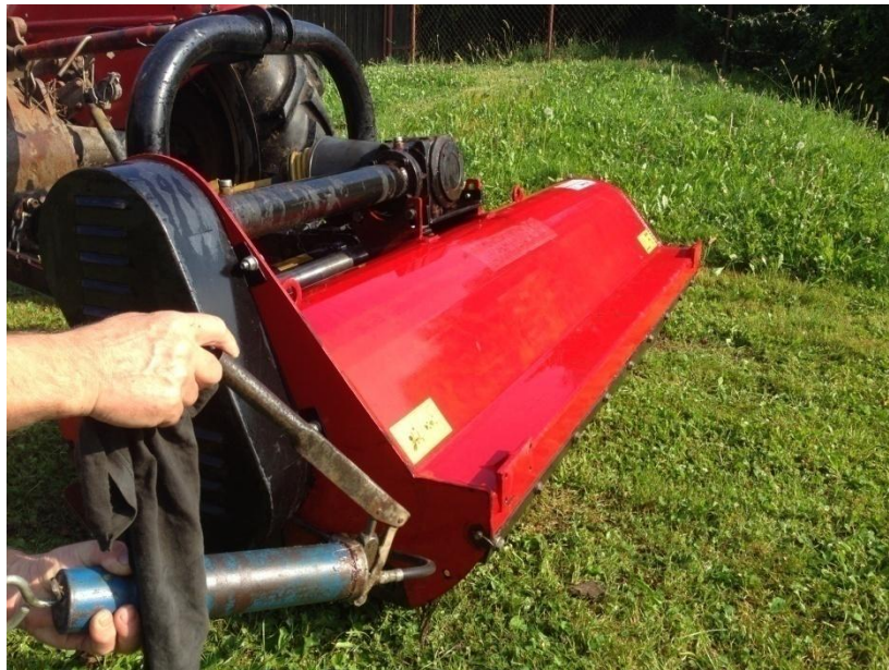
Slika 9. Podmazivanje ležajeva na malčeru
