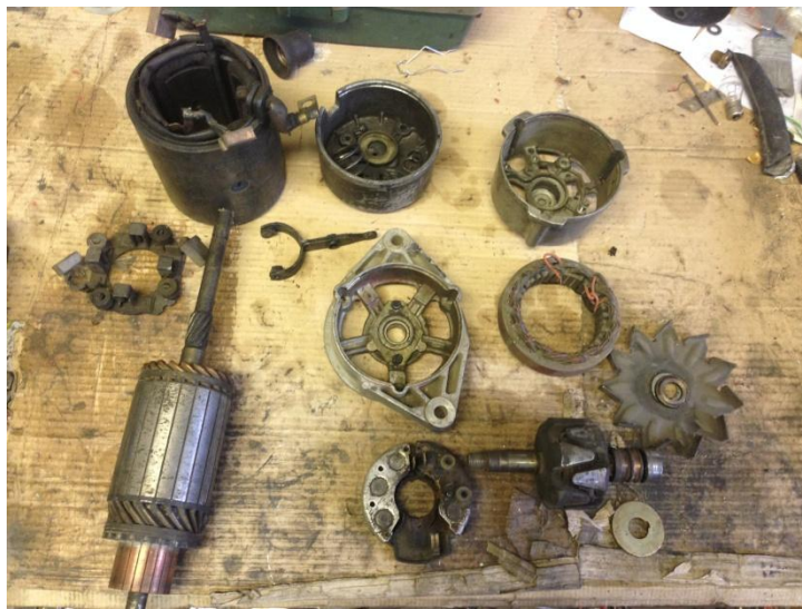
Slika 7. Dijelovi elektropokretača i alternatora
