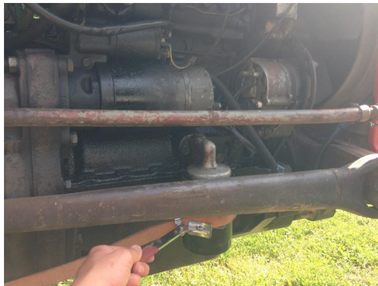
Slika 6. Izmjena pročistača ulja
