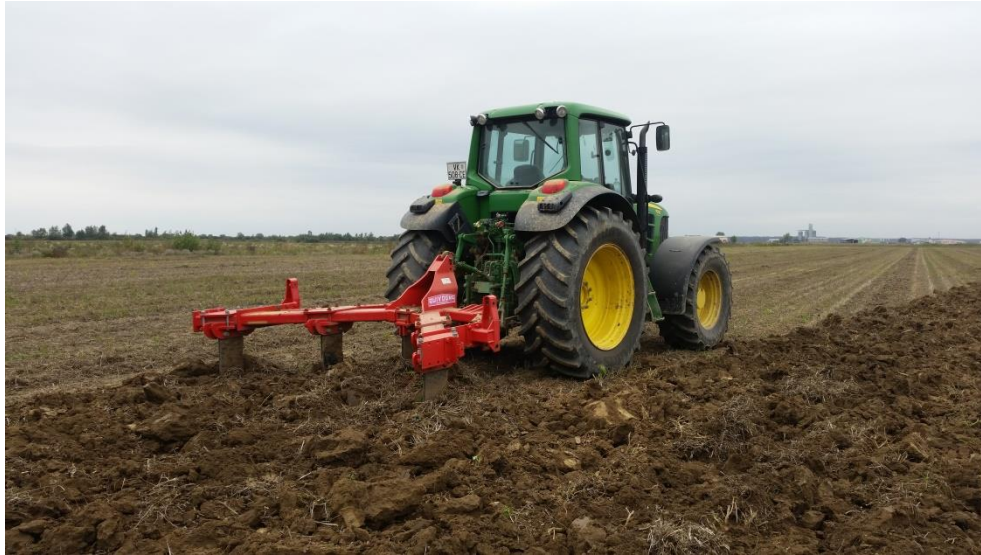
Slika 4. Dubinska obrada tla podrivačem Quivogne (foto: Trutin)
