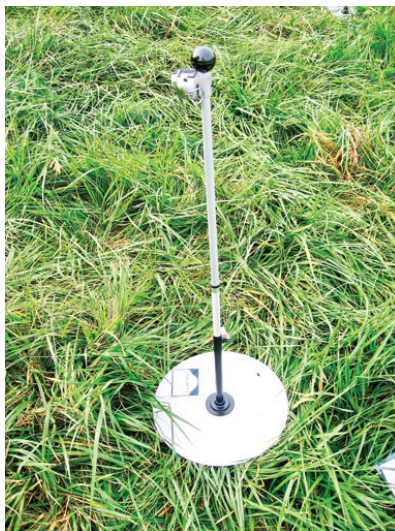
Slika 1. Mjerač za procjenu prinosa trave
