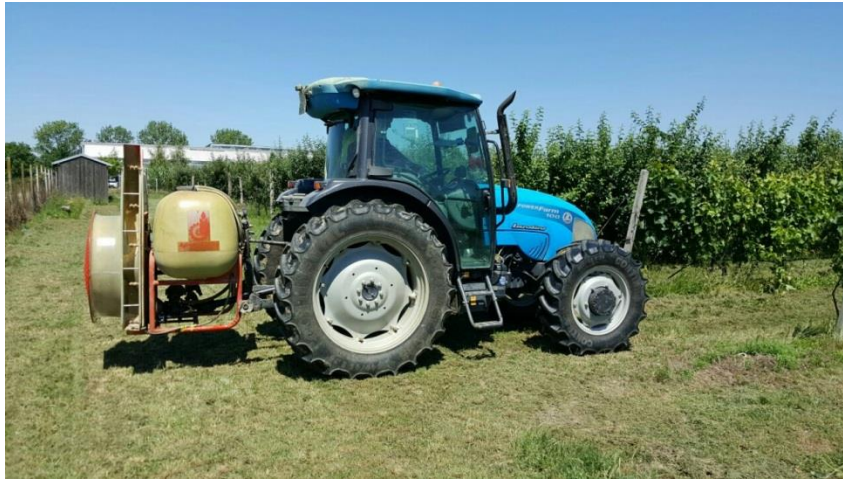
Slika 4. Traktor agregatiran s raspršivačem (vlastita fotografija)
