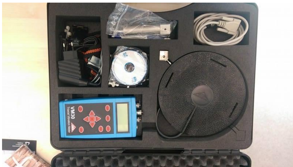
Slika 8. Uređaj za mjerenje vibracija „MMF VM30“ (vlastita fotografija)
