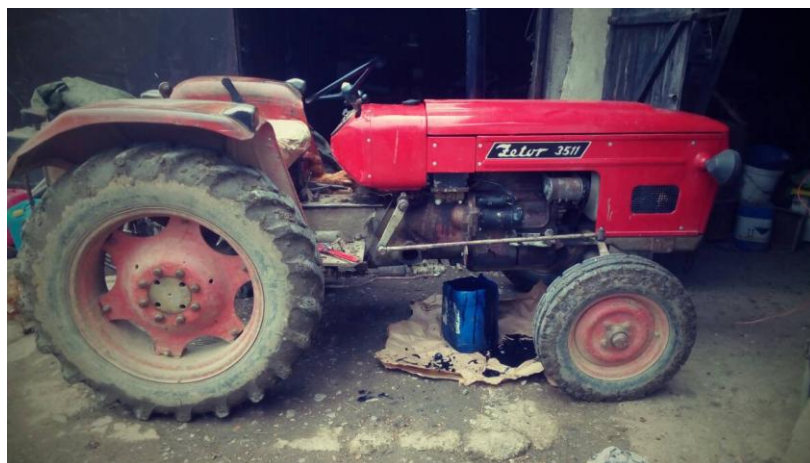
Slika 10. Ispuštanje ulja iz traktorskog motora
