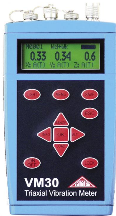
Slika 9. Uređaj za mjerenje vibracija MMF VM30-H
