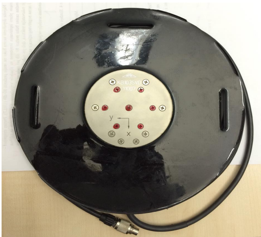
Slika 5. Prikaz pravaca osi koje se mjere (vlastita fotografija)
