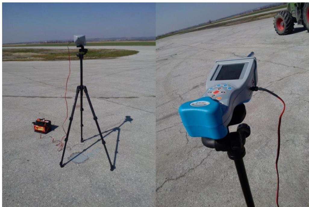
Slika 5. Pozicioniranje uređaja za mjerjenje pri vanjskom mjerenu buke traktora (vlastita fotografija )
