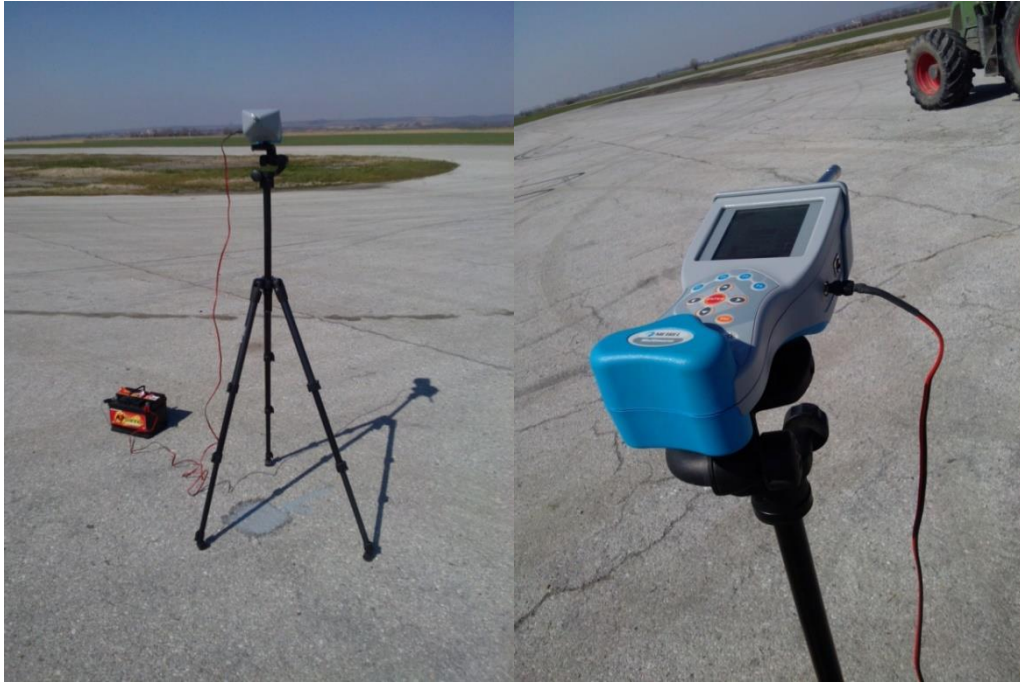
Slika 5. Pozicioniranje uređaja za mjerenje pri vanjskom mjerenju buke traktora (vlastita fotografija )
