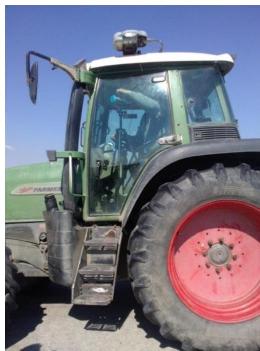
Slika 6. Mjerjenje buke u kabini traktora i postavljanje uređaja (vlastita fotografija)
