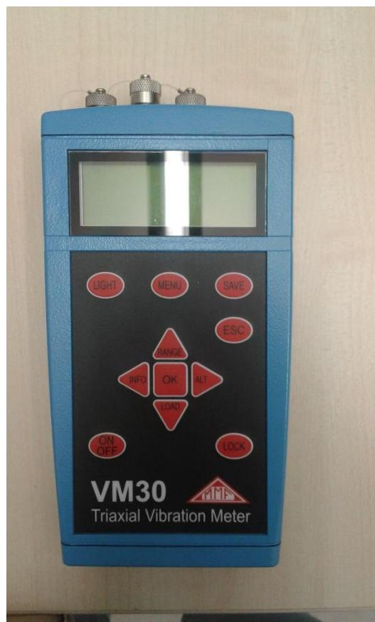
Slika 6. Uređaj za mjerjenje razine vibracija MMF VM 30 (vlastita fotografija)
