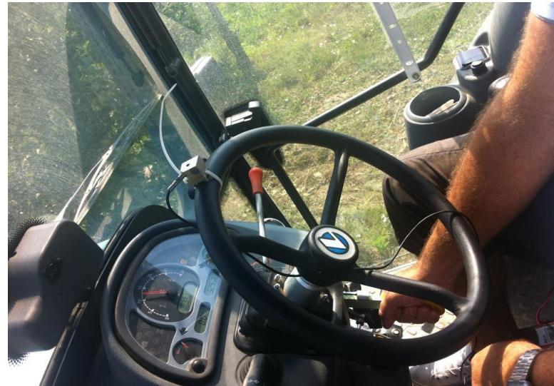
Slika 7. Senzor uređaja za mjerjenje razine vibracija (vlastita fotografija)
