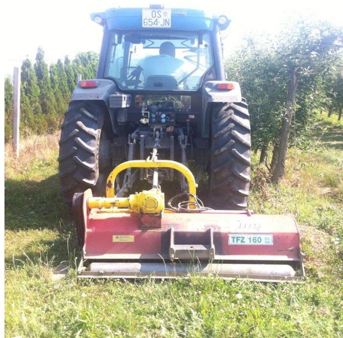
Slika 8. Mjerenje razine vibracija prilikom rada malčera (vlastita fotografija)
