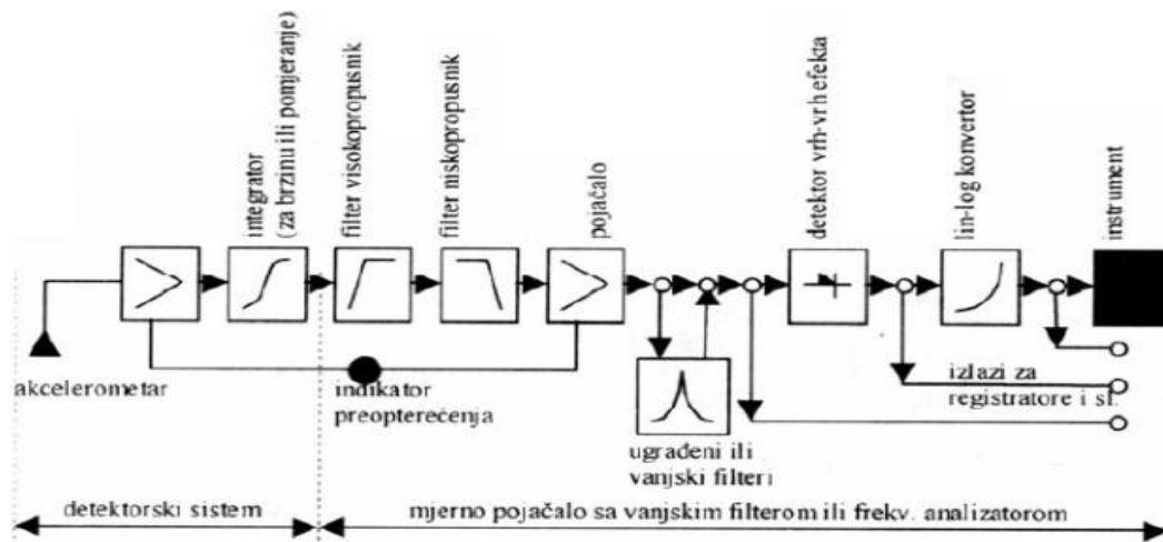
Slika 3. Shema mjernog lanca za mjerjenje vibracija (Poplašen i Kerner, 2013.)
