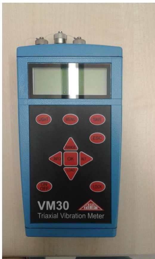
Slika 6. Uređaj za mjerenje razine vibracija MMF VM 30 (vlastita fotografija)
