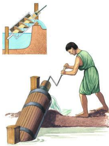
Slika 8. Arhimedov vijak kao pumpa za podizanje vode
