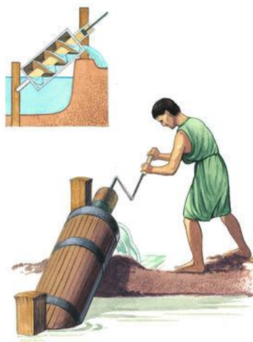
Slika 8. Arhimedov vijak kao pumpa za podizanje vode
