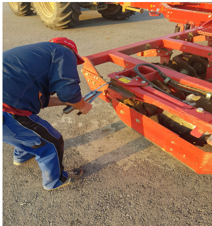
Slika 4. Podmazivanje radnog stroja mazalicom (Izvor: vlastita fotografija)
