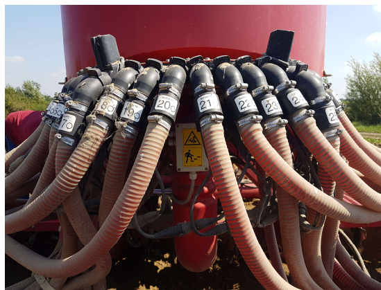
Slika 15. Razvodnik s motornim zasunima (Izvor: vlastita fotografija)
