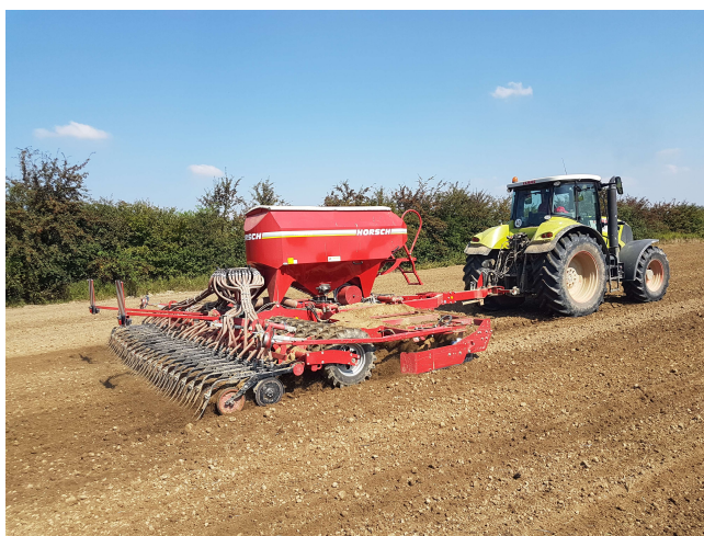
Slika 7. Sijačica „Horsch Pronto 6 DC“ i traktor „Claas Axion 850“ u radu (Izvor: vlastita fotografija)
