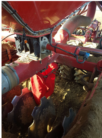
Slika 19. Ispuštanje sjemena u vreću (Izvor: vlastita fotografija)
