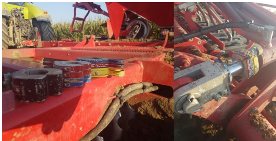
Slika 21. Aluminijske kopče i pritisak ulagača – hidraulični (Izvor: vlastita fotografija)
