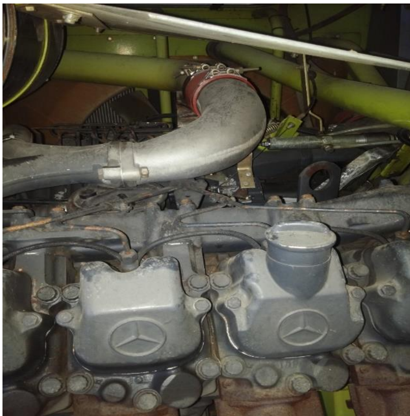
Slika 8. MercedesBenzov motor snage 268 kW (Izvor : Kolak, I.)
