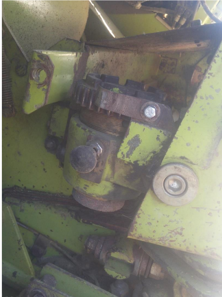
Slika 14. Brus za oštrenje noževa u položaju kada se ne upotrebljava. (Izvor : Kolak, I.)
