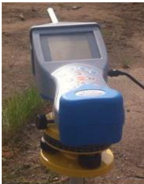
Slika 4. Uređaj METREL tipa Multinorm MI 6201 EU (Vlastiti izvor)
