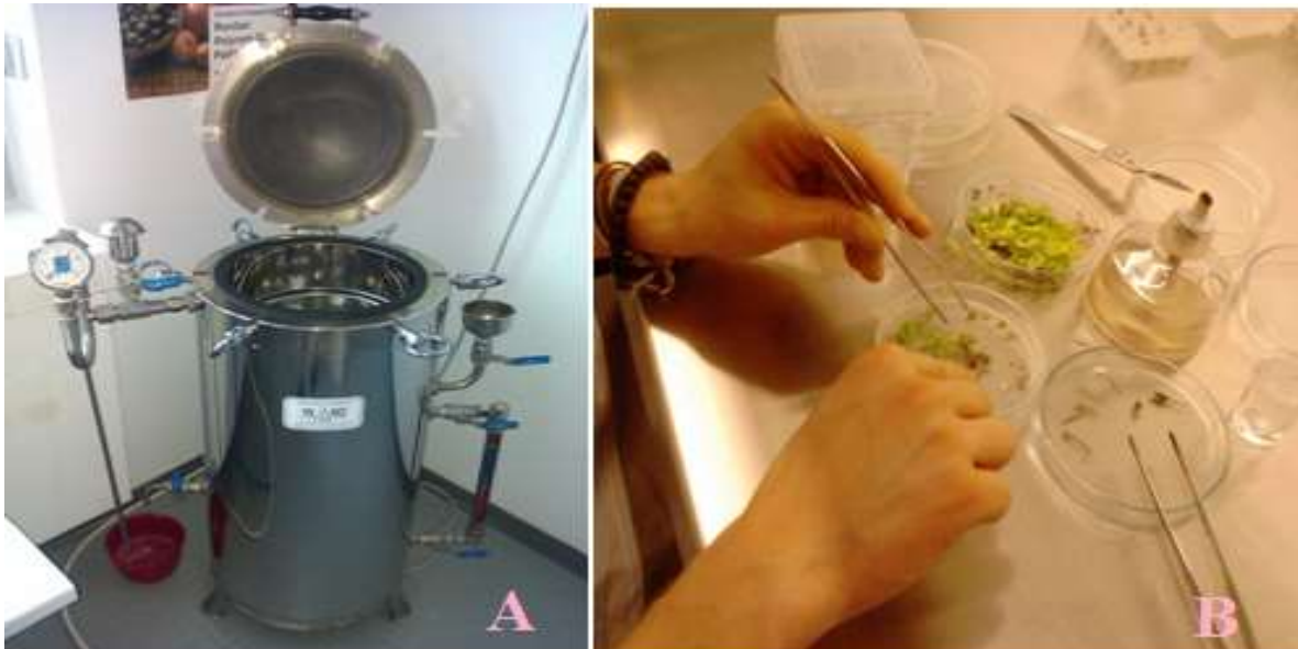
Slika 3: Parni sterilizator-autoklav (A) i prikaz ostale laboratorijske opreme korištene pri pripremi eksplantanta- pincete, petrijeve zdjelice, nož, plamenik (B) (foto: Tkalec, M.)
