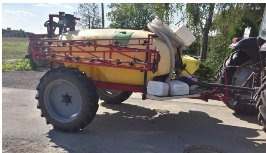
Slika 7. Prskalica za kemijsku zaštitu soje (Izvor: Marin Garac)
