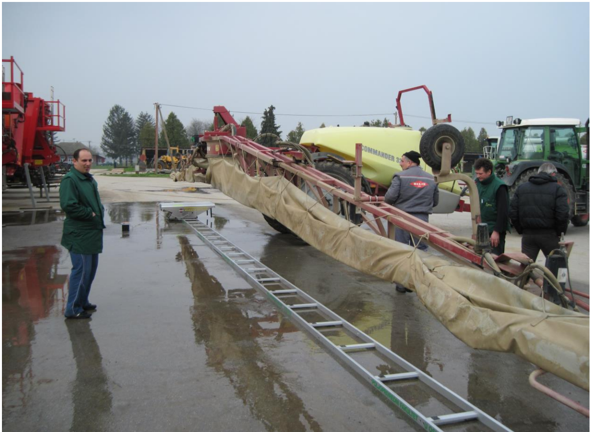
Slika 17. Testiranje površinske raspodjele tekućine na prskalici Hardi Commander L – 336
