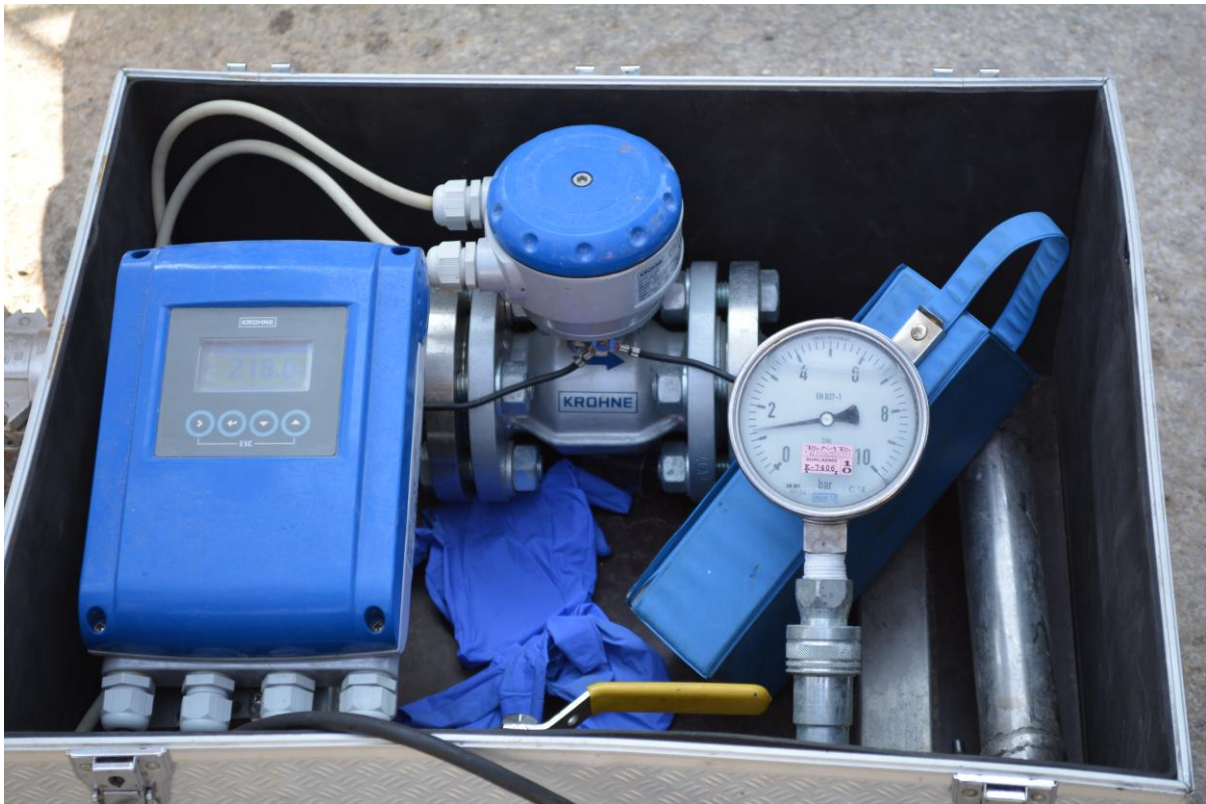
Slika 4. Elektromagnetni mjerač kapaciteta crpke tvrtke Krohne
