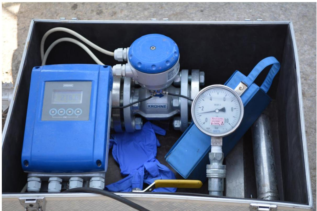
Slika 4. Elektromagnetni mjerač kapaciteta crpke tvrtke *Krohne*
