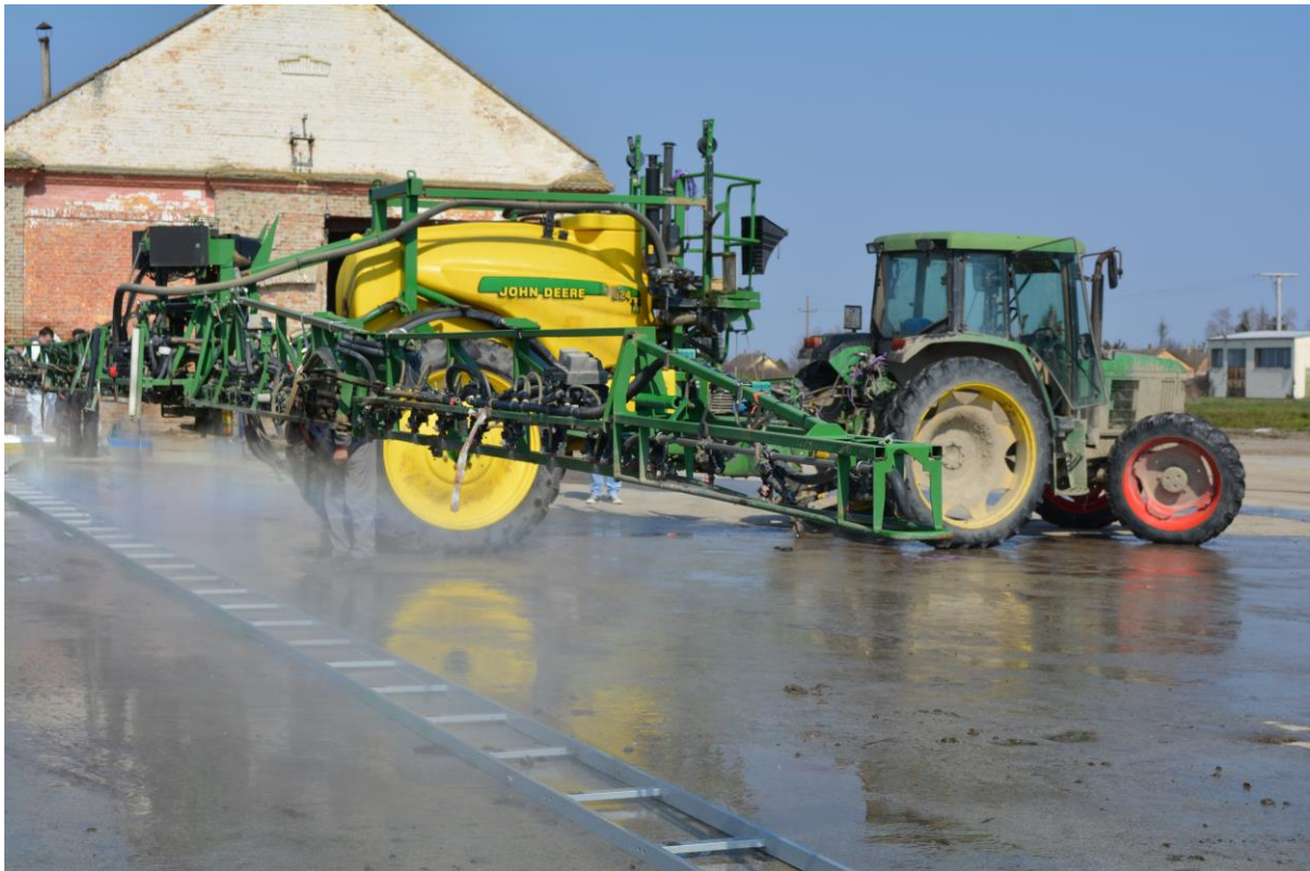
Slika 19. Raspodjela tekućine pri radu prskalice tvrtke John Deere 3172
