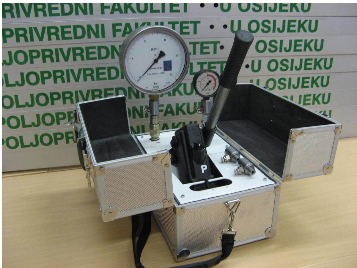
Slika 5. Ispitivanje ispravnosti rada manometra
