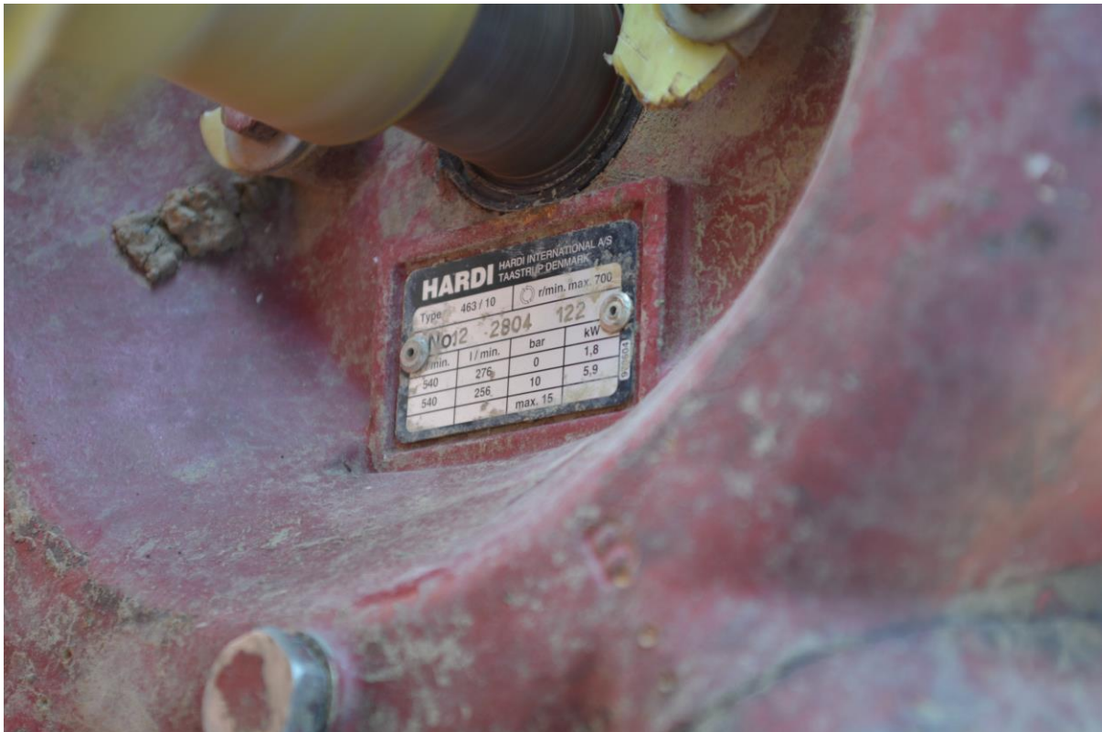
Slika 3. Tehničke odlike crpke tipa 463/10, serijskog broja 12 2804 122
