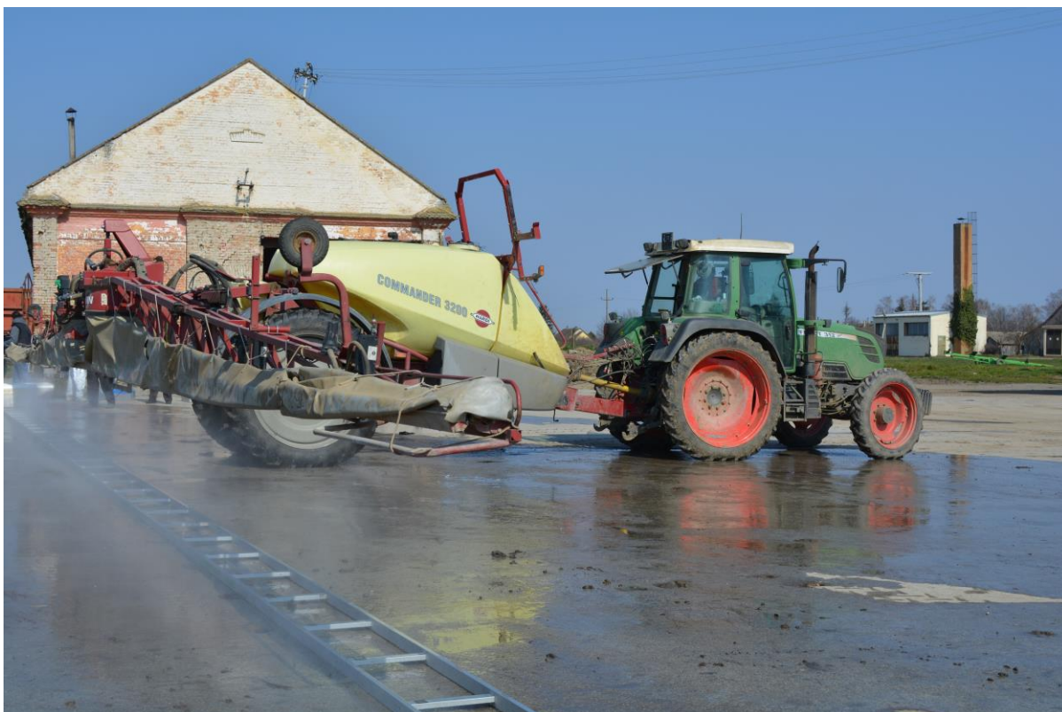
Slika 13. Testiranje raspodjele tekućine pri radu prskalice Hardi Commander L – 215
