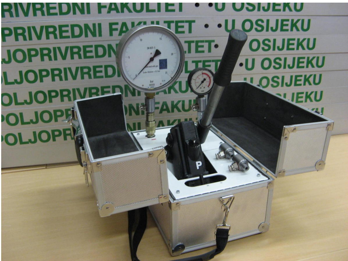
Slika 5. Ispitivanje ispravnosti rada manometra
