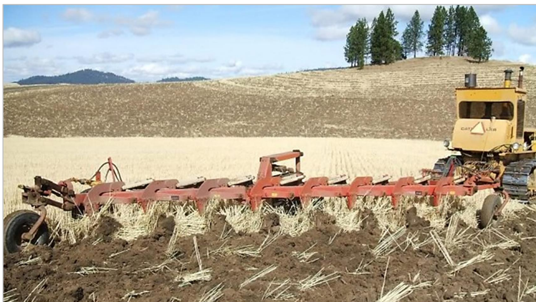
Slika 3. Zaoravanje biljnih ostataka (Izvor: http://www.agrivi.com )
