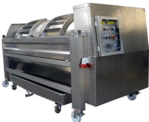
**Slika 3: Horizontalna pneumatička preša**
