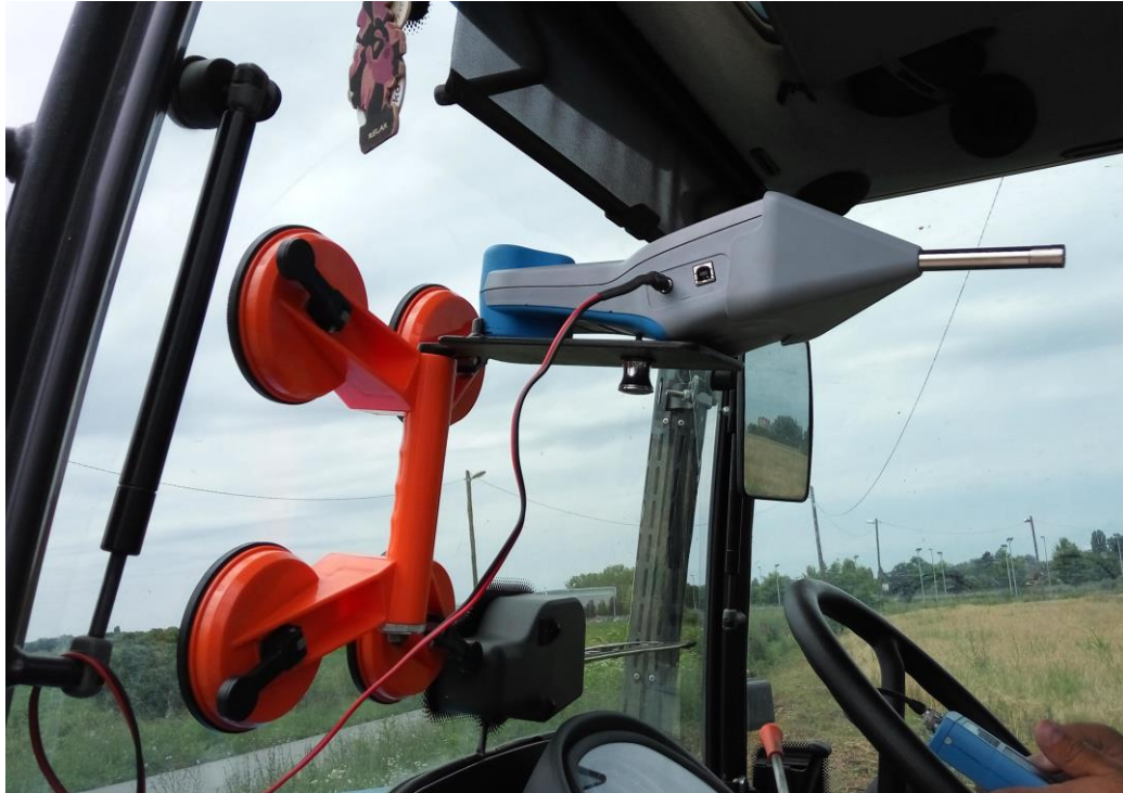
Slika 7. Položaj uređaja u odnosu na referentnu točku sjedala rukovatelja (Vlastita fotografija)
