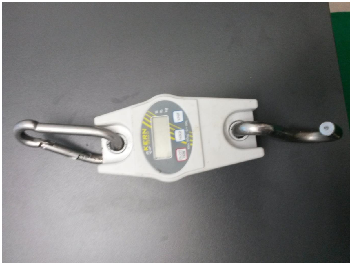
Slika. 13. Digitalna vaga za mjerenje mase uzoraka ( Autor, 2016. )
