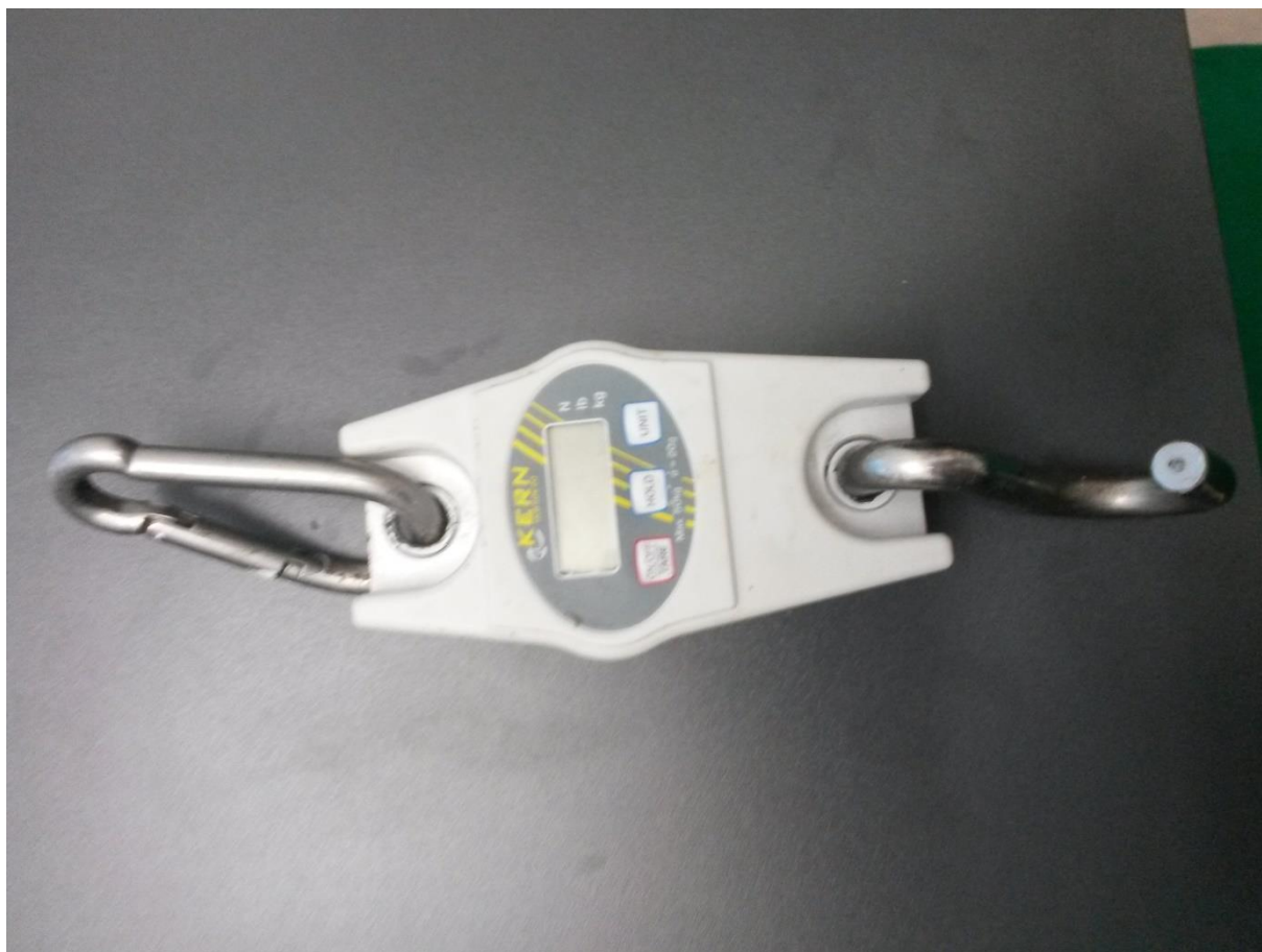
Slika. 13. Digitalna vaga za mjerenje mase uzoraka ( Autor, 2016. )
