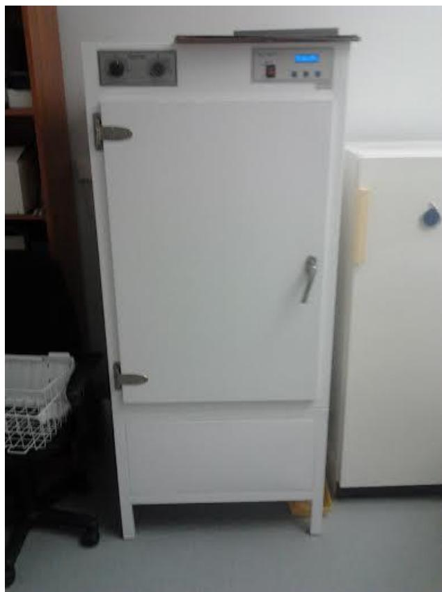
Slika 6. Komora za držanje uzoraka na 30°C
