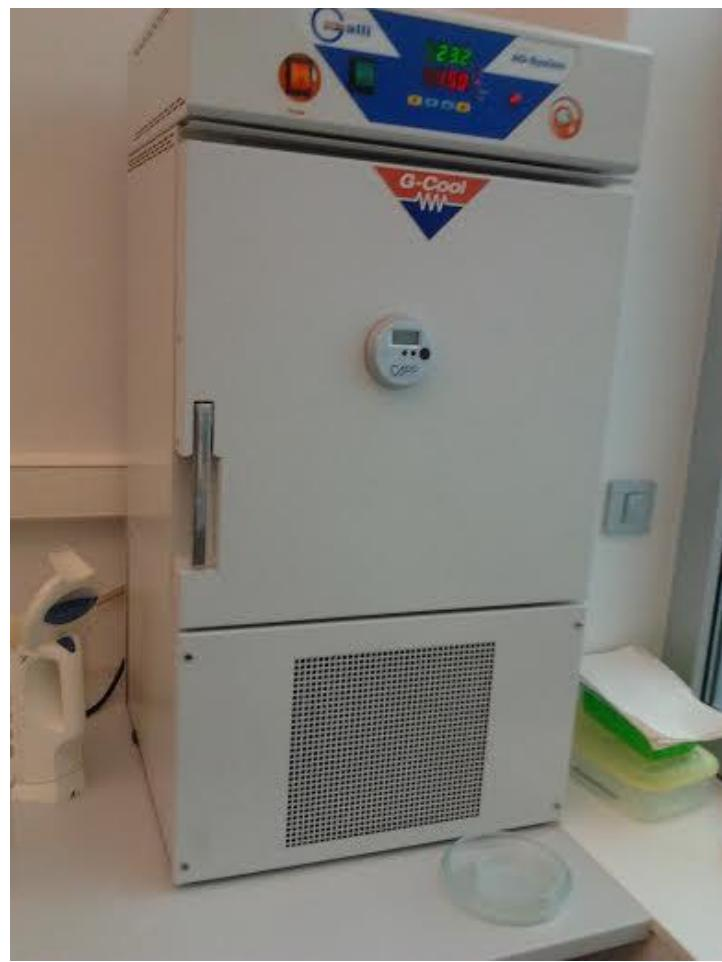
Slika 7. Komora za držanje uzoraka na 15 °C
