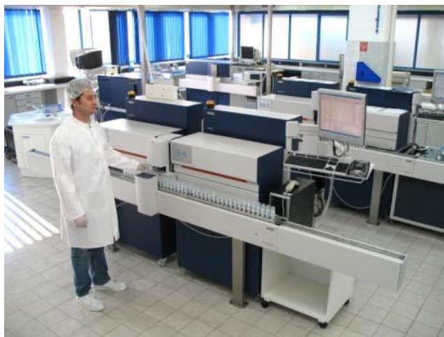
Slika 12. Analiza mlijeka fluoro-opto-elektronskom metodom
