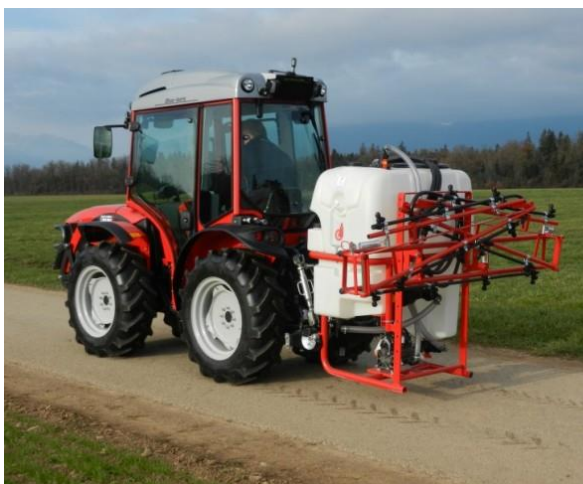
Slika 4. Nošena prskalica Agromehanika AGS 200-400 EN/L, Izvor:
