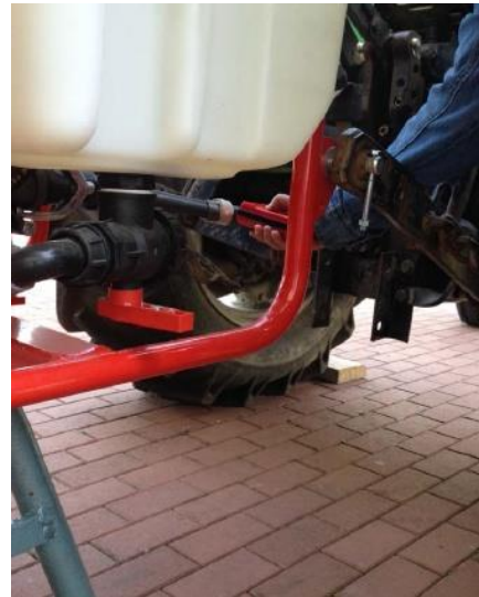
Slika 2. Tahometar Ornel HT 441
