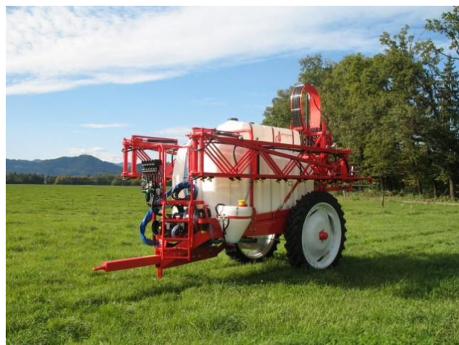
Slika 5. Vučena prskalica Agromehanika AGS 3000 EN H, Izvor:
