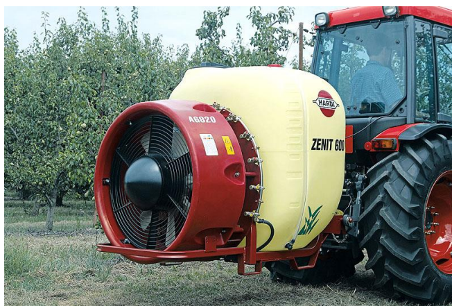
Slika 6. Raspršivač s aksijalnim ventilatorom Hardi Zenit, Izvor: http://www.palmmach.com/agriculture-implements-hardi.html
