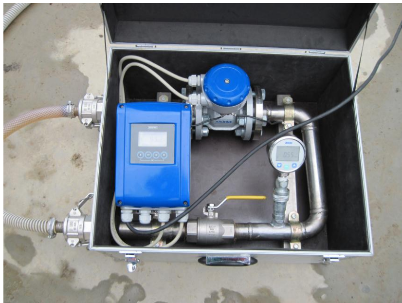
Slika 14. Uređaj za kontrolu protoka crpke Krohne
