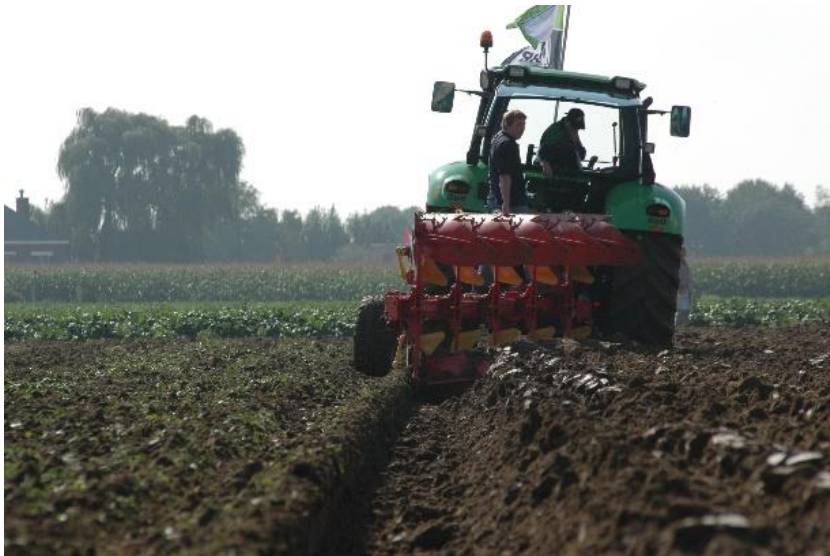
Slika 9. Oranje plugom premetnjakom ( Izvor: https://www.northersound.ie )
