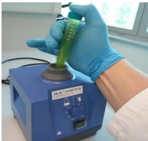
Slika 4. Miješanje uzorka tkiva na vrtložnoj treskalici.
