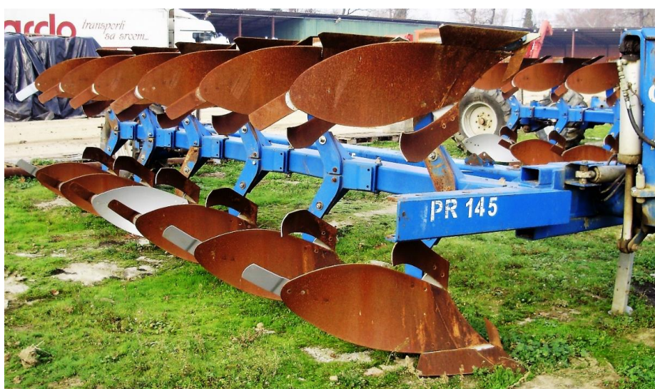
Slika 33. Okretni plug Överum Xcelsior EX 6975 F (foto: I. Andrić)
