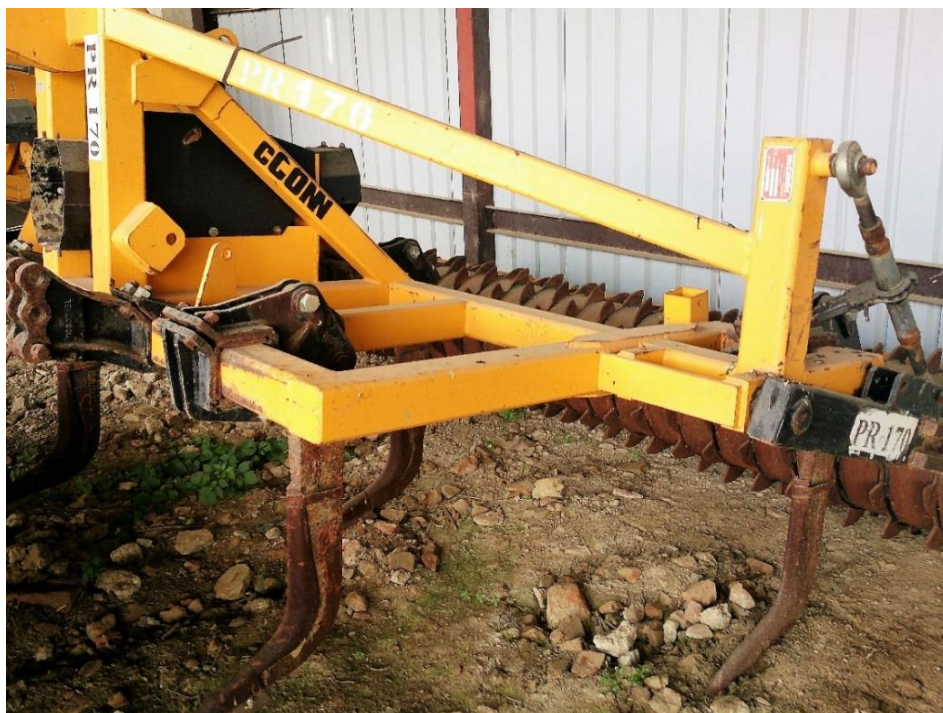
Slika 34. Podrivač McConnell 3M Vibro Aerator (foto: I. Andrić)
