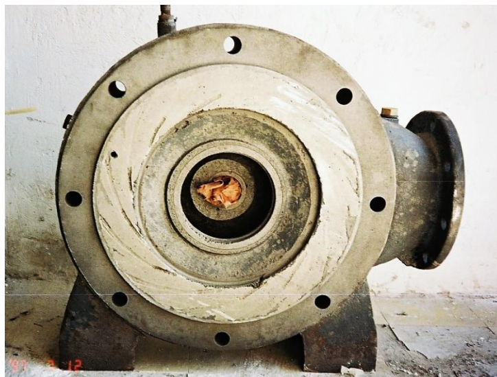
Slika 18. Erozijska korozija brtvene površine crpke (Izvor: http://belzona.hr/tag/erozija/ )
