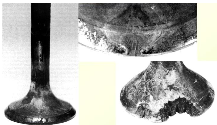
Slika 4. Oštećenja sjedišta ventila zbog kemijske korozije (Medica, 2010.)
