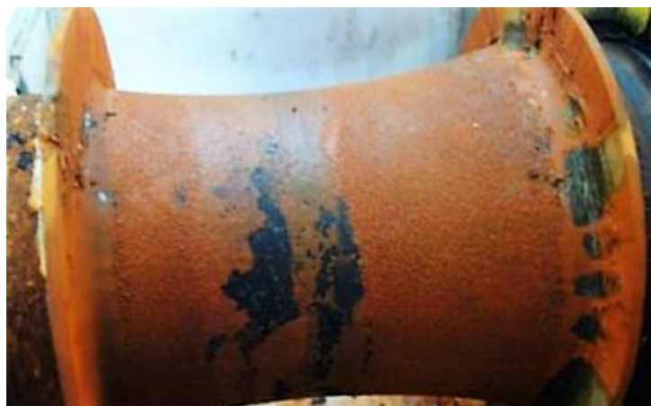
Slika 17. Korozijski zamor dijela osovine
