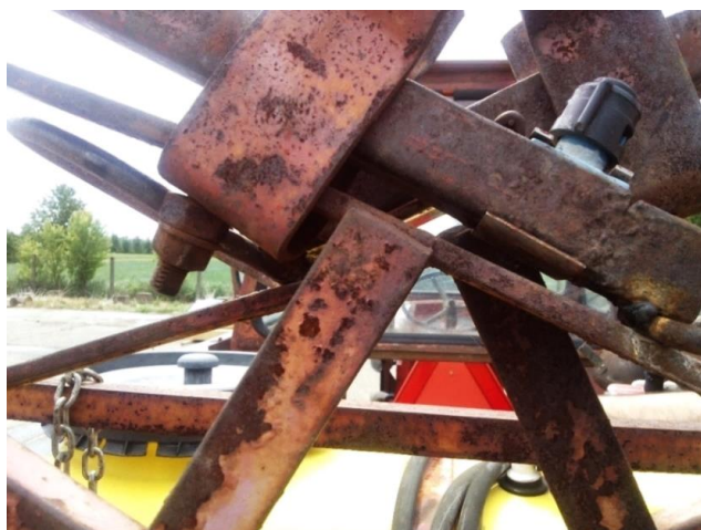
Slika 8. Neravnomjerna opća korozija prskalice (Izvor: Zavod za mehanizaciju PF Osijek)
