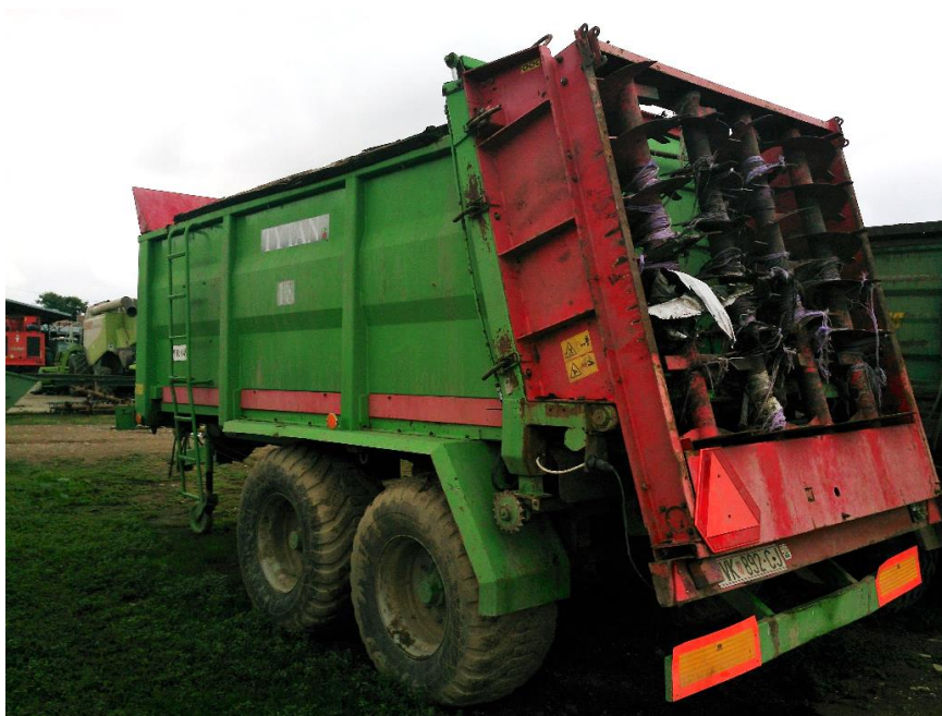
Slika 39. Prikolica za razbacivanje krutog stajskog gnojiva TYTAN 18 (foto: I. Andrić)
