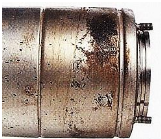
Slika 11. Rupičasta (pitting) korozija dijela osovine od nehrđajućeg čelika
