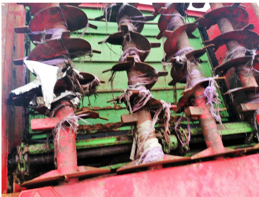
Slika 40. Uređaj za razbacivanje krutog stajskog gnojiva (foto: I. Andrić)
