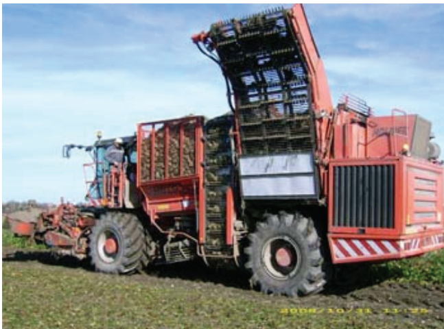
Slika 9. Kombajn za vađenje šećerne repe „Holmer“
