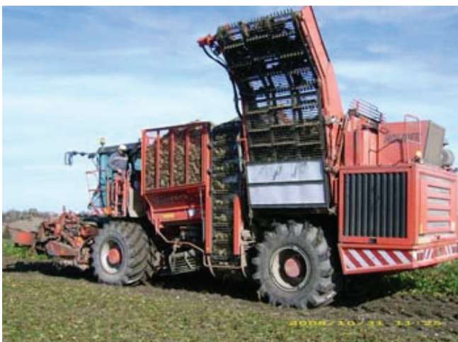
Slika 9. Kombajn za vađenje šećerne repe „Holmer“
