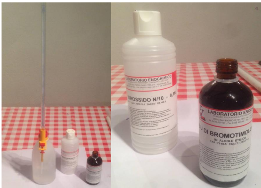
Slika 15. Potreban pribor i otopine za određivanje ukupne kiselosti mošta (Autor, 2014.)
