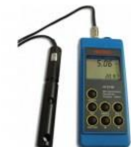
Slika 28. uređaj za mjerenje koncentracije kisika u vodi
